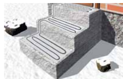
Ułożenie przewodu grzejnego jednożyłowego
